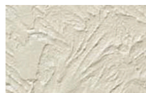
低汚染アクリル樹脂塗料 テカリがあり、質感を損なう
